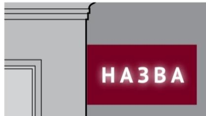
Вмонтовані на торці кронштейна (освітлюється від зовнішнього контуру).
