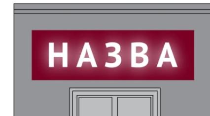
Вмонтовані на торці вивіски (освітлюється від зовнішнього контуру).
