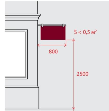
Кронштейну у вигляді об'ємно-просторової композиції. При цьому його крайня точка виносу не повинна виступати від стіни більше ніж на 800 мм, а відстань від його нижньої точки до поверхні тротуару не може бути меншою ніж 2,5 м.
