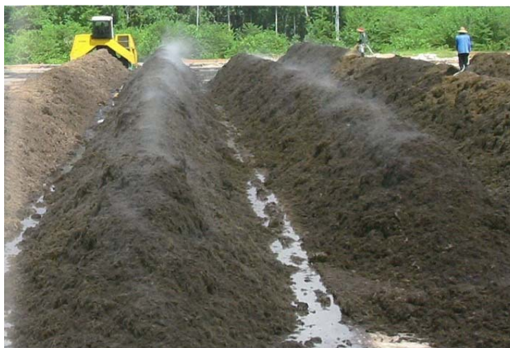
Рисунок 1.11 – Відкрита система компостування у трикутних грядах (джерело: https://tehnix.hr/en/ )
