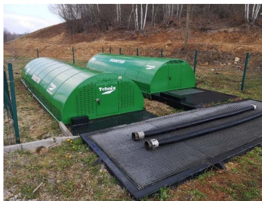
Рисунок 1.6 – Приклади закритої системи компостування у біобарабані (джерело: https://tehnix.hr/en/ )
