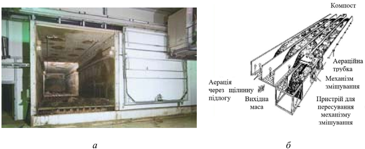
Рисунок 1.3 – Приклад компостування в тунелю (а) та у рядах (буртах) (б)
