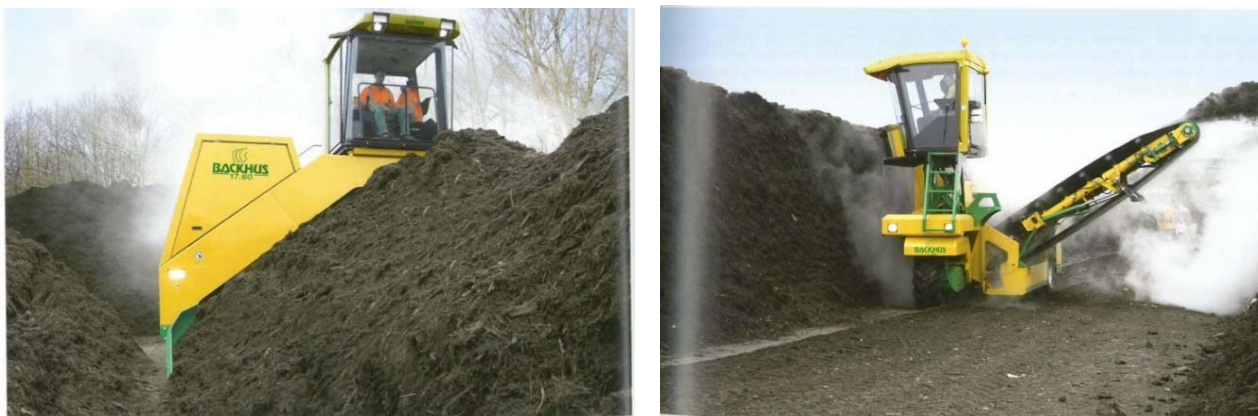
Рисунок 1.12 – Відкрита система компостування у трикутних та плоских буртах (джерело: https://tehnix.hr/en/ )
