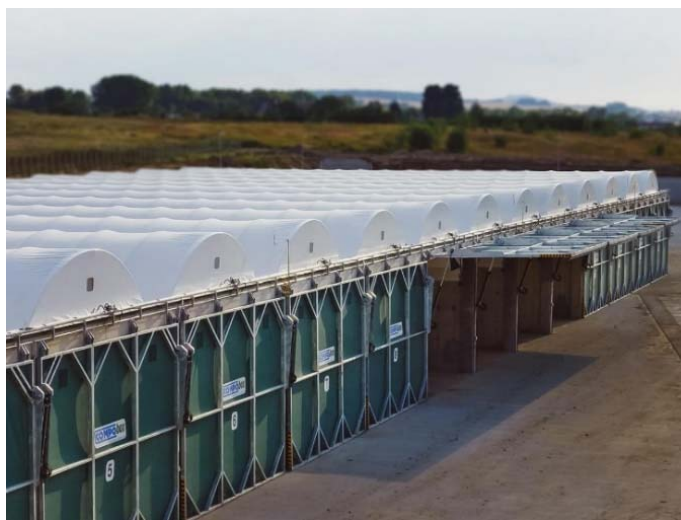
Рисунок 1.7 – Приклад закритої системи компостування у боксі (джерело: https://www.compost-systems.com/en/solutions/box-composting )
