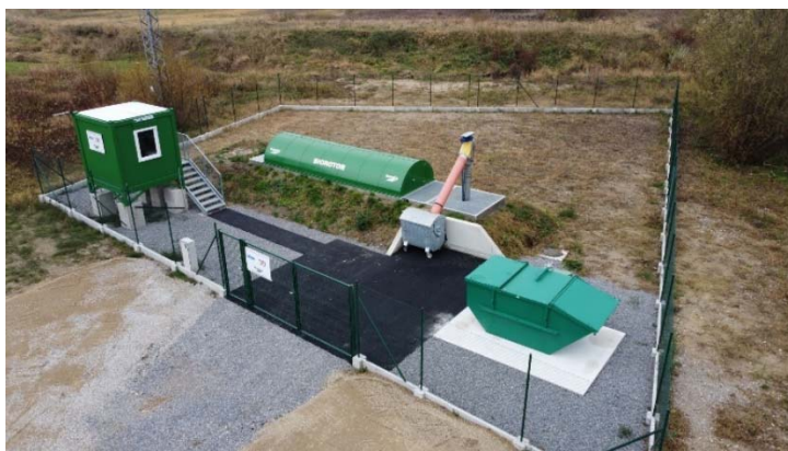
Рисунок 1.6 – Приклади закритої системи компостування у біобарабані (джерело: https://tehnix.hr/en/ )
