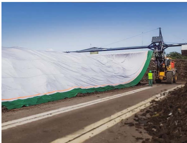
Рисунок 1.5 – Компостування у буртах з мембраною (джерело: https://www.compost-systems.com/en/solutions/windrow-composting-membrane )
