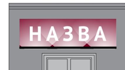
Винесені на зовнішніх кронштейнах (освітлюється частина фасаду разом із вивіскою).
